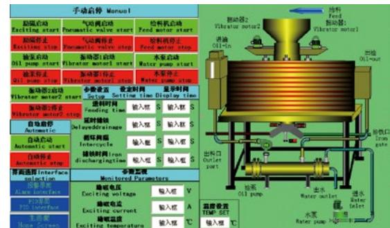
◆通过传感器、变送器采集现场数据，根据用户给定的选矿工艺参数，运用先进的 PID 控制理论（恒流），设备无论热态或者冷态，快速使控制系统达到额定的激磁场强。解决了以往设备热态运行时，磁场强度下降；激磁上升速度慢等缺点。
